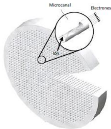
Figura 0.9. Representación esquemática de la configuración de una placa microcanal o MCP y modo de funcionamiento de los canales.
