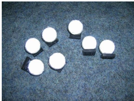
Figura 9. Marcadores reflectantes que se colocan sobre la superficie corporal
