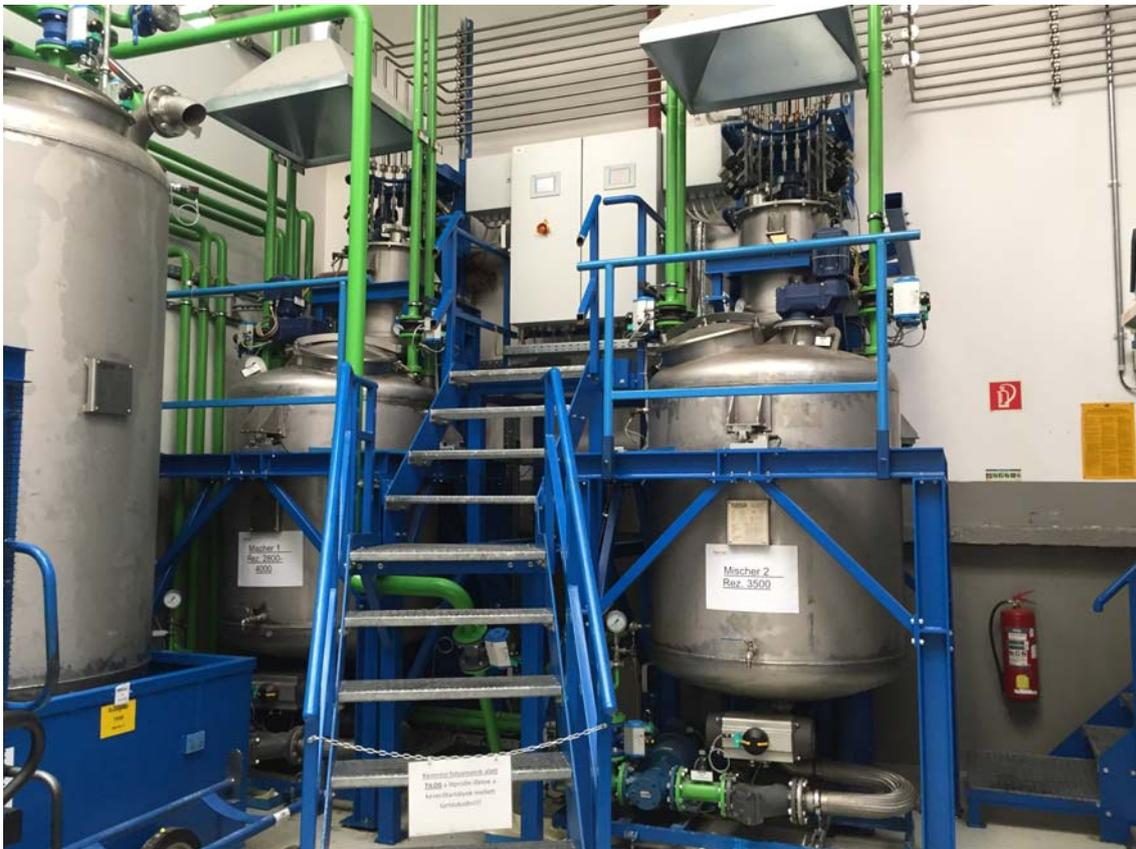
*Figura 1: Ejemplo reactor de mezclado*
