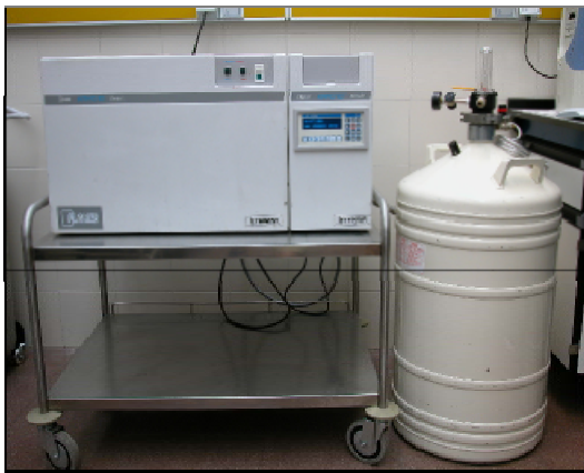
Congelación de las pajuelas (-20°C/min hasta -100 °C) en el biocongelador programable.
