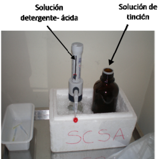
200 \mu L de la muestra + 400 \mu L del detergente durante 30 seg después 1,2 mL de a sol. de tinción
