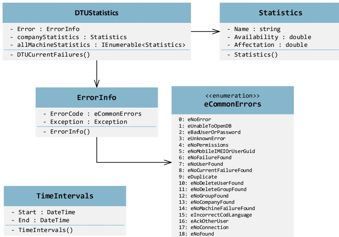
Figura 5.39.- Diagrama de clases DTUStatistics
