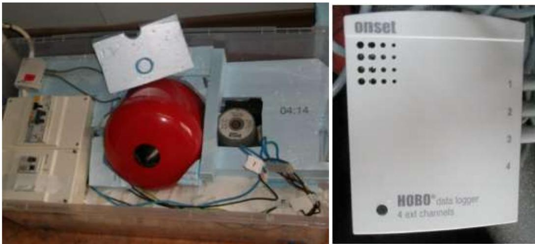
**Figura 2.** Equipo TRT y dispositivo Data logger HOBO U12-006 utilizados en el sondeo geotérmico.
