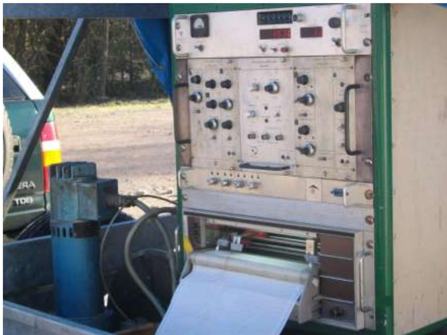
**Figura 1.** Equipo de testificación MOUNT SOPRIS 3000
