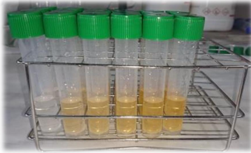
Figura 17: Tubos con diferentes concentraciones de glucosa para la realización de la recta de calibrado.
