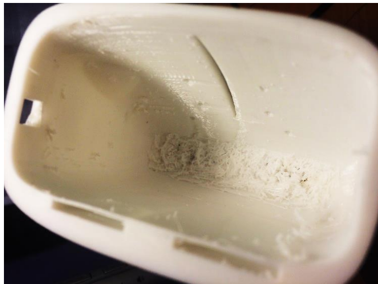
Fig. 4.120 Defecto visual del guante en la zona del pulgar
