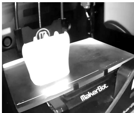
Fig. 4.118 Orientación del guante para su impresión
