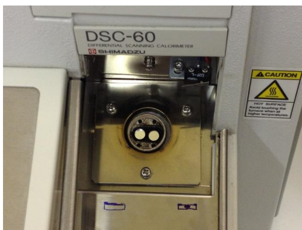
Fig. 4.96 Ampliación de zona de alojamiento de los crisoles en el calorímetro
