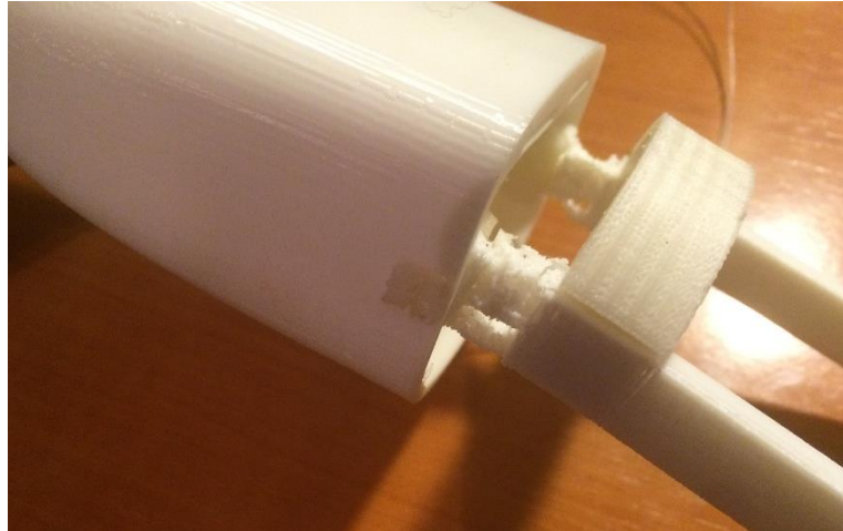
Fig. 4.133 Unión de ambas partes mediante los eslabones
