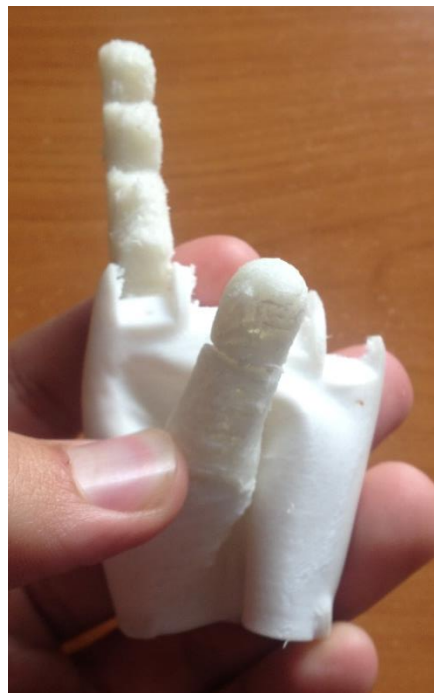
Fig. 4.36 Deformación del guante de la prótesis Flexy-Hand 2 – Filaflex Remix
