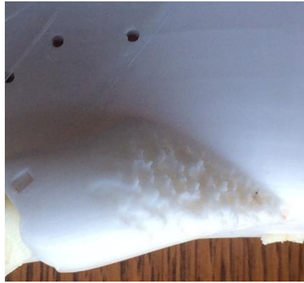
Fig. 4.120 Defecto visual del guante en la zona del pulgar
