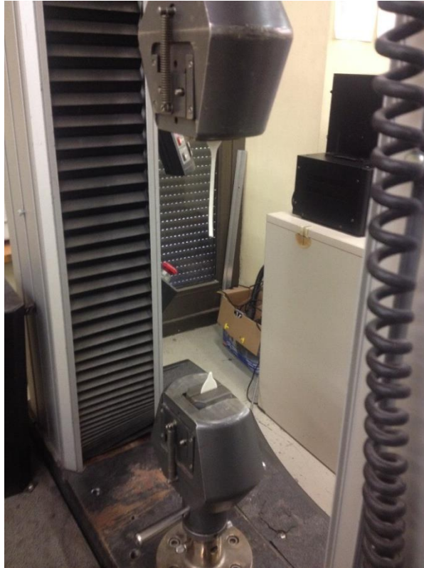
Fig. 4.88 Probeta de PLA flexible en la máquina de ensayo de tracción
