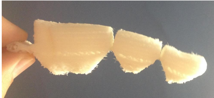
Fig. 4.39 Recuperación al estado inicial del dedo de la prótesis Flexy-Hand 2 – Filaflex Remix
