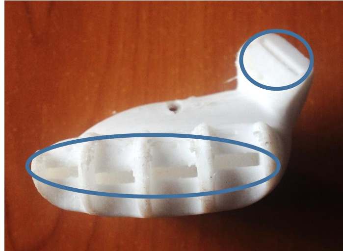
Fig. 4.29 Vista en planta del guante de Flexy-Hand 2 – Filaflex Remix con las muescas de unión de los dedos
