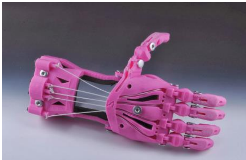
Fig. 4.26 Prótesis Cyborg Beast impresa en 3D (Fuente: MakerBot Thingiverse)
