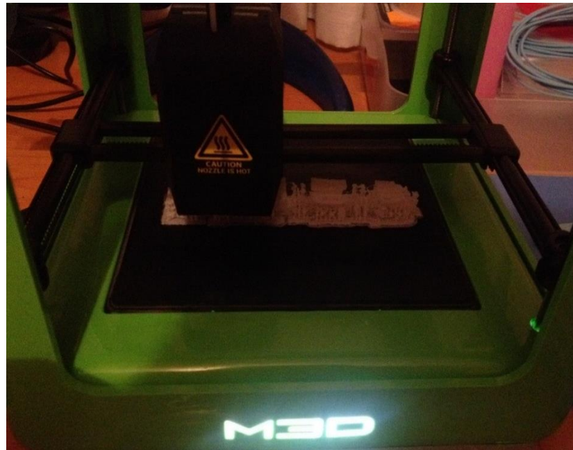
Fig. 4.37 Momento de impresión de un dedo de Flexy-Hand 2 – Filaflex Remix a tamaño real
