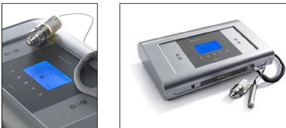
**Figura 4-3.** Vista del equipo de electroporación utilizado con un detalle del aplicador roll-on.
