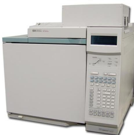
Fig. 9. Cromatógrafo de gases Agilent HP-6890N.
