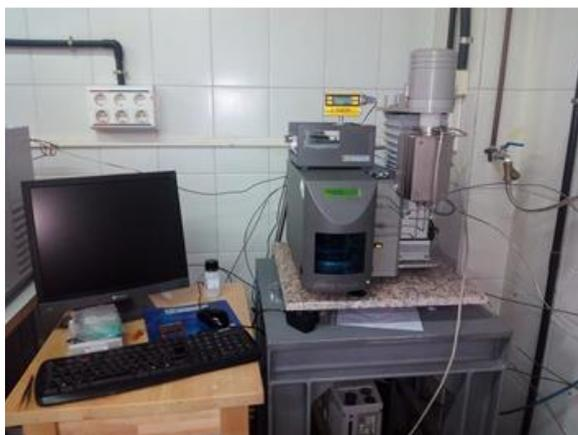
Fig. 13. Sensys de Setaram para análisis termogravimétrico.
