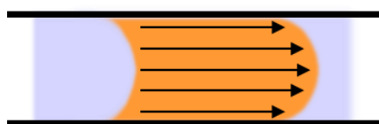
Figura 1.20. Perfil de velocidad de las partículas de un líquido en un flujo laminar generado por presión.
