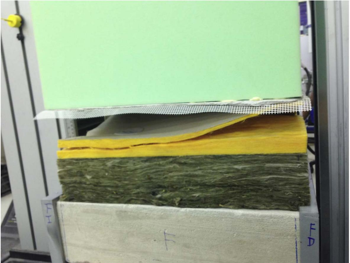
**Ilustración 15: Estado de la probeta tras el ensayo del Static Foam Block Test**
