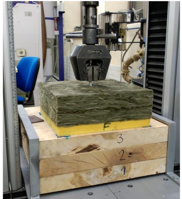
**Ilustración 8: Vista general del ensayo Pull-Through**
