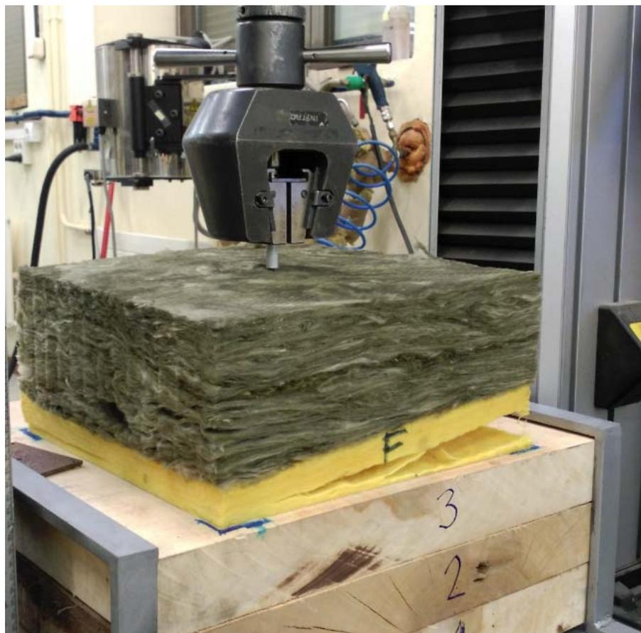
Ilustración 17: Estado de la probeta tras el ensayo del Pull-Through Test of Fixings
