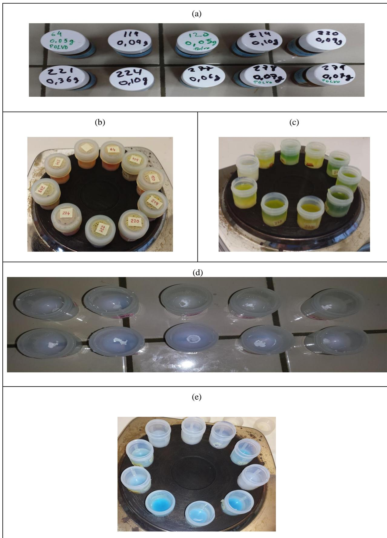
**Figura 8:** Imágenes ilustrativas de las diferentes etapas del proceso: a) Muestra inicial; b) Digestión de la muestra; c) Evaporación; d) Residuo de la evaporación; e) Redisolución.
