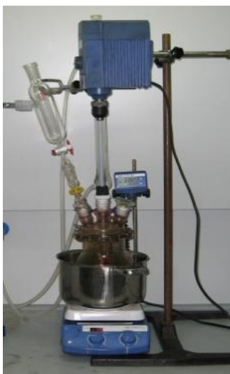
Figura 10. Reactor de 3 bocas donde se realizó el método Hummers.
