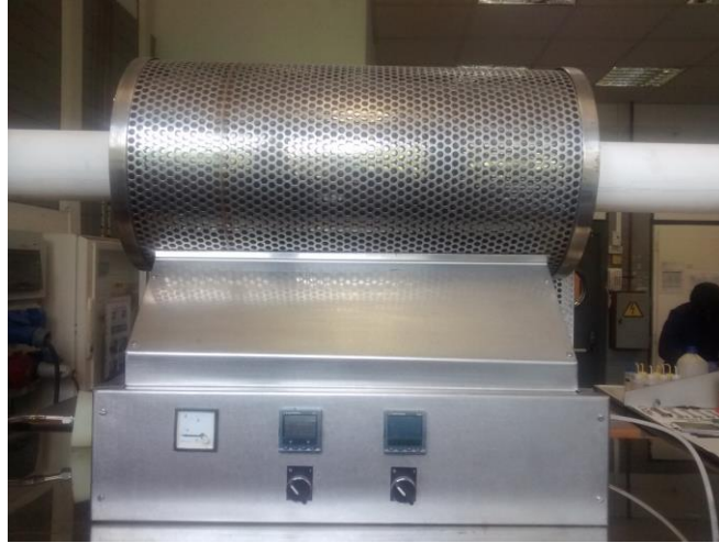
Figura 12. Horno horizontal utilizado para la reducción térmica.
