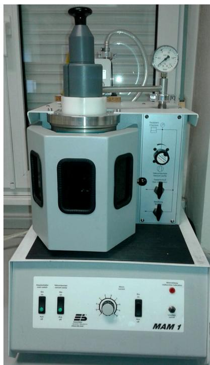
*Figura 2.1: Imagen del horno eléctrico empleado en la síntesis del lingote de la aleación Heusler Ni-Mn-Sn estudiada.*
