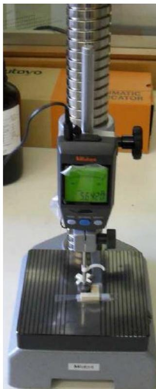
Figura 4.19. Micrómetro vertical Mitutoyo ID-H0560
