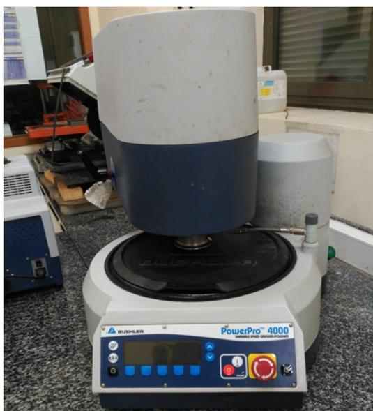
Figura 4.14. Pulidora automática PowerPro 4000 de la marca Buehler
