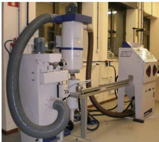
Figura 4. 4. Máquina de Shot Peening
