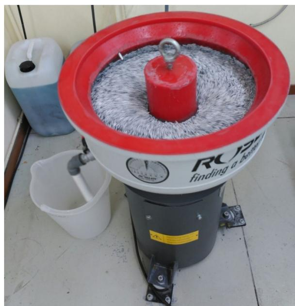
Figura 4.8. Rösler Mini 30 en funcionamiento
