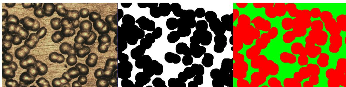
**Figura 4.6. Superficie expuesta al flujo de proyectiles durante 1s.**
