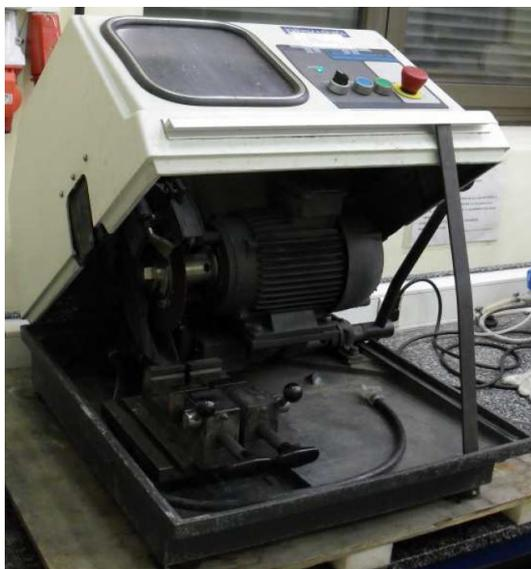
Figura 4.2. Cortadora manual Buehler
