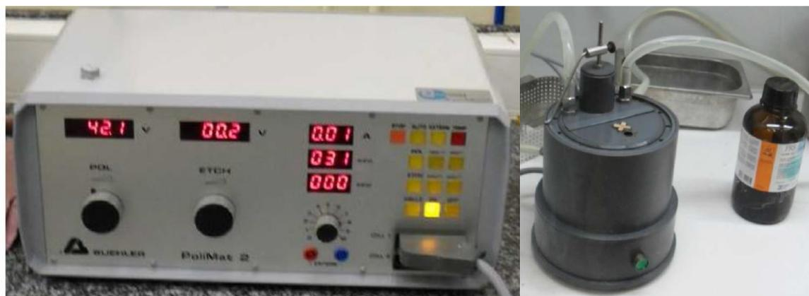
Figura 4.18. Fuente eléctrica y celda galvánica utilizada para electropulido
