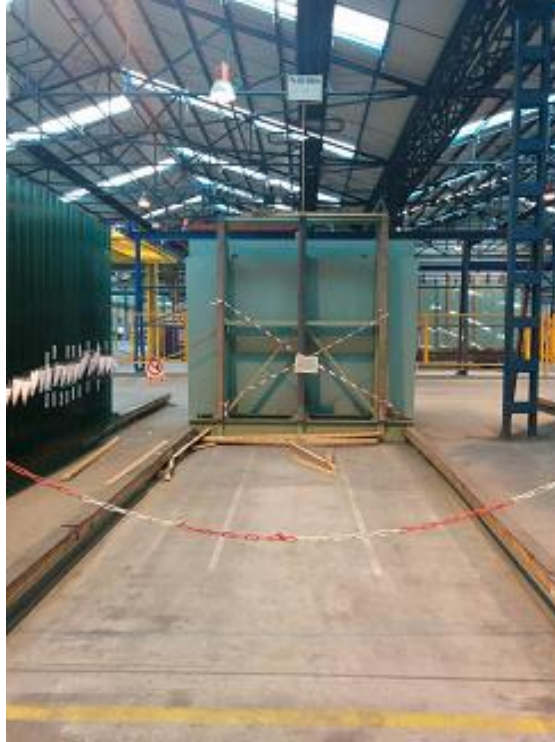
Figura 6: Caballete vacío para reparar, en el que se puede ver la estructura metálica de acero, la madera en el respaldo y las patas y el fieltro que cubre la madera.
