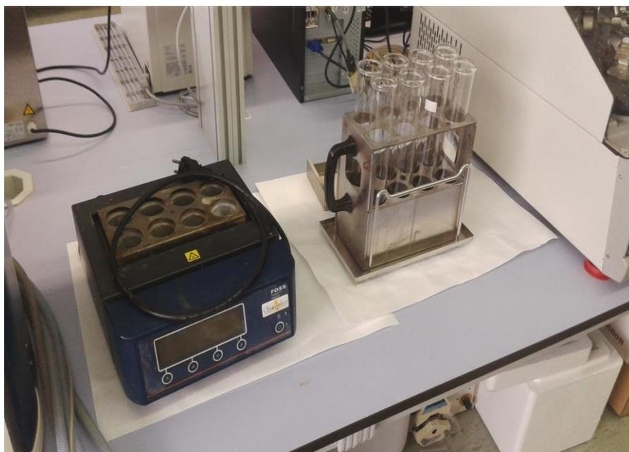
*Figura 19. Calentador y tubos Kjeldahl para la realización de la hidrólisis.*
