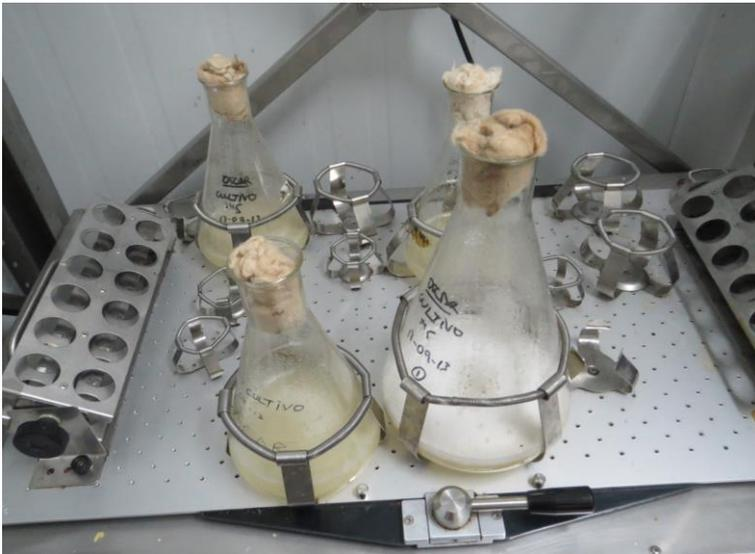
**Figura 22.** Crecimiento levaduras en cámara termostatzada y con agitación
