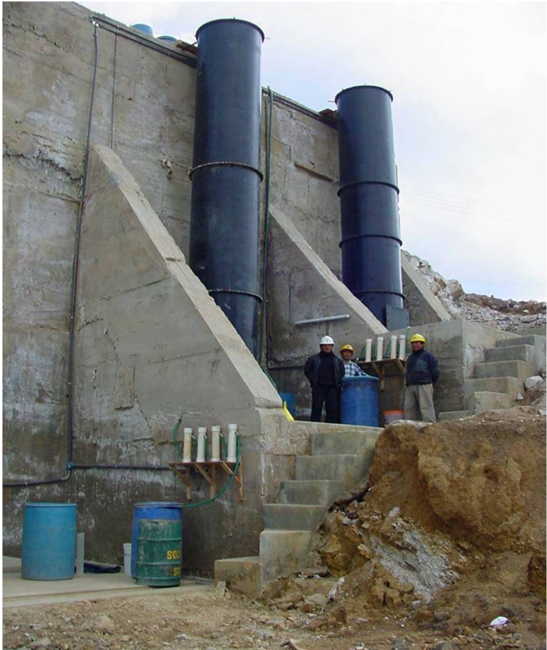
Figura 71. Lixiviación por cianuración de arcillas en columnas piloto de 1.2 mt \varnothing x 6 mt altura
