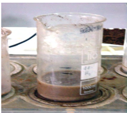
Fig 13. Cuando el líquido baja de la señal inferior es el momento de restaurar los niveles y comprobar la efervescencia
