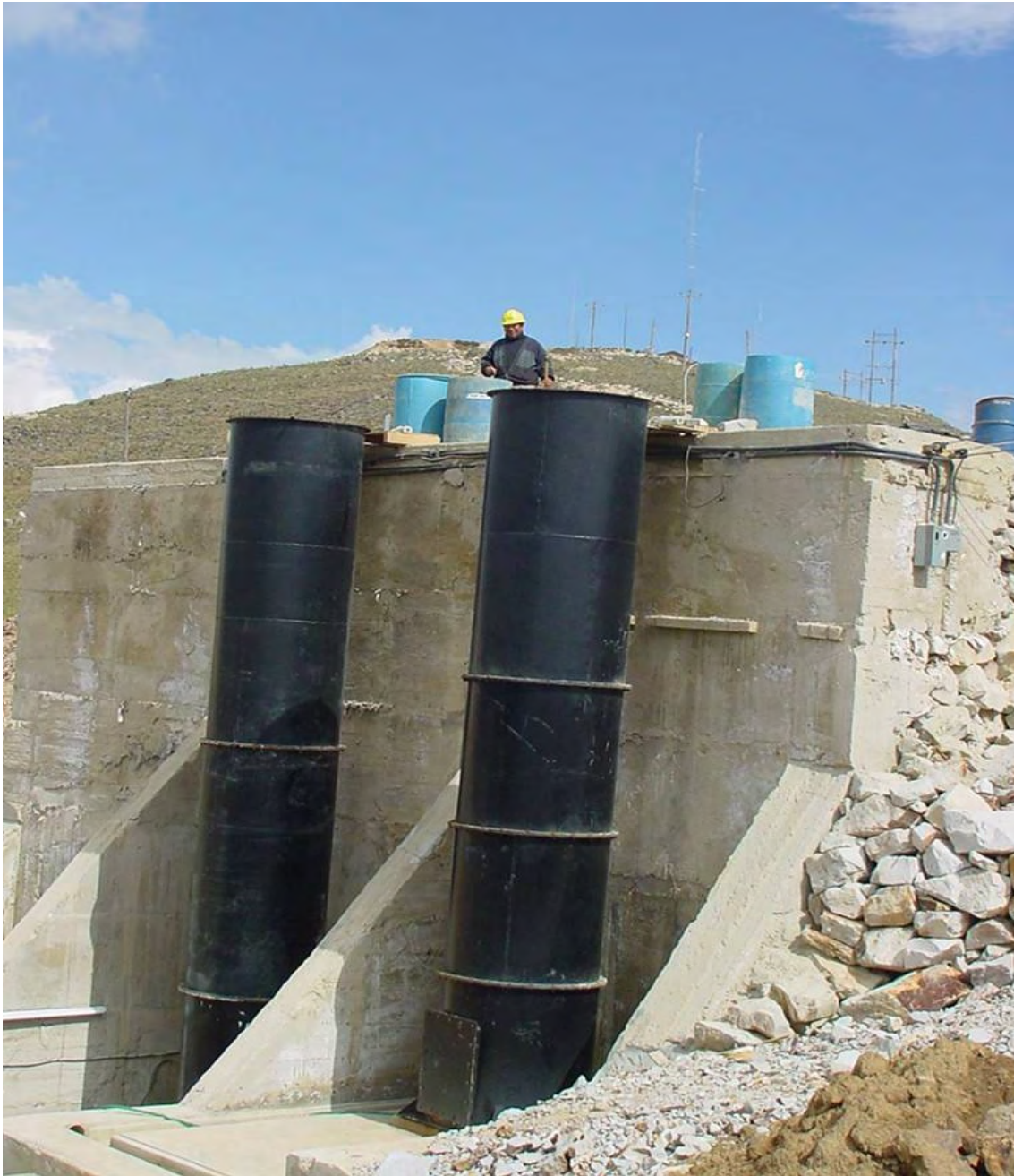
Figura 72. Lixiviación por cianuración de arcillas en columnas piloto de 1.2 m \varnothing x 6 y 8 m de altura.
