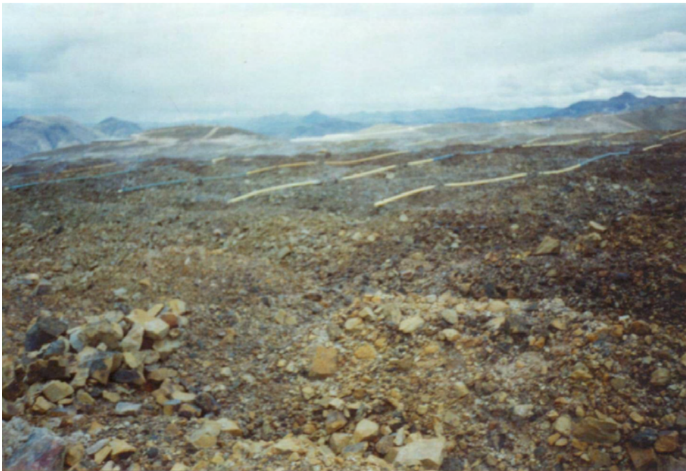
Figura 75. Lixiviación por heap leaching de arcillas vía sistema por aspersión.
