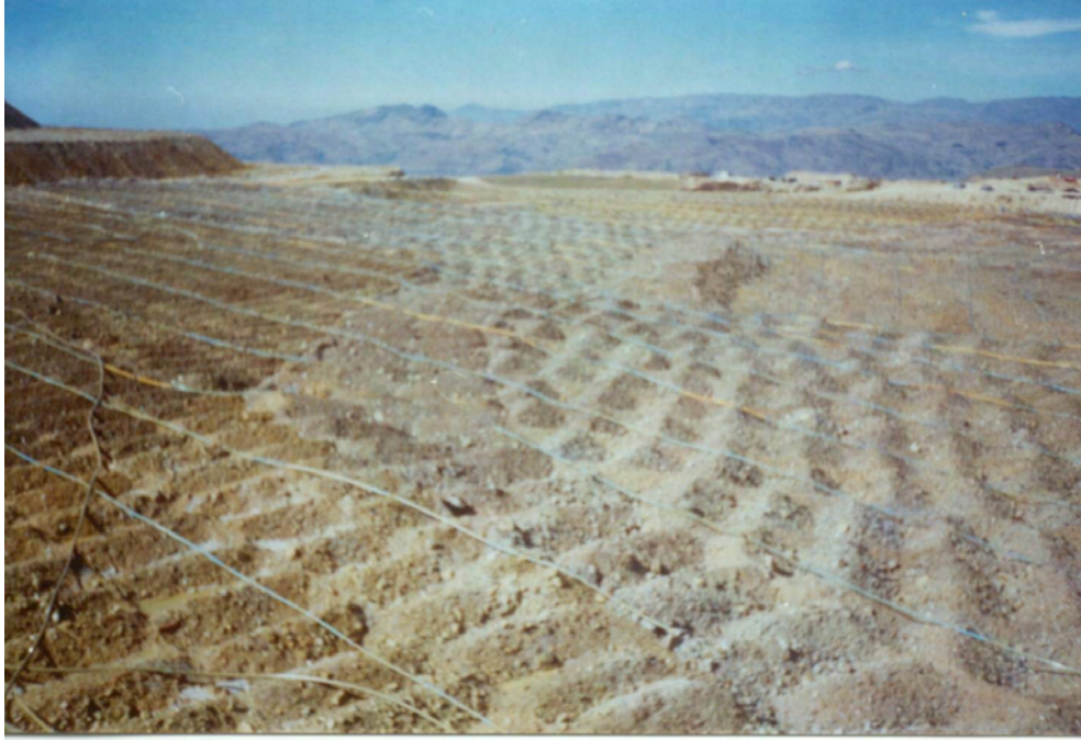
Figura 74. Lixiviación industrial por heap leaching de arcillas vía sistema por goteo
