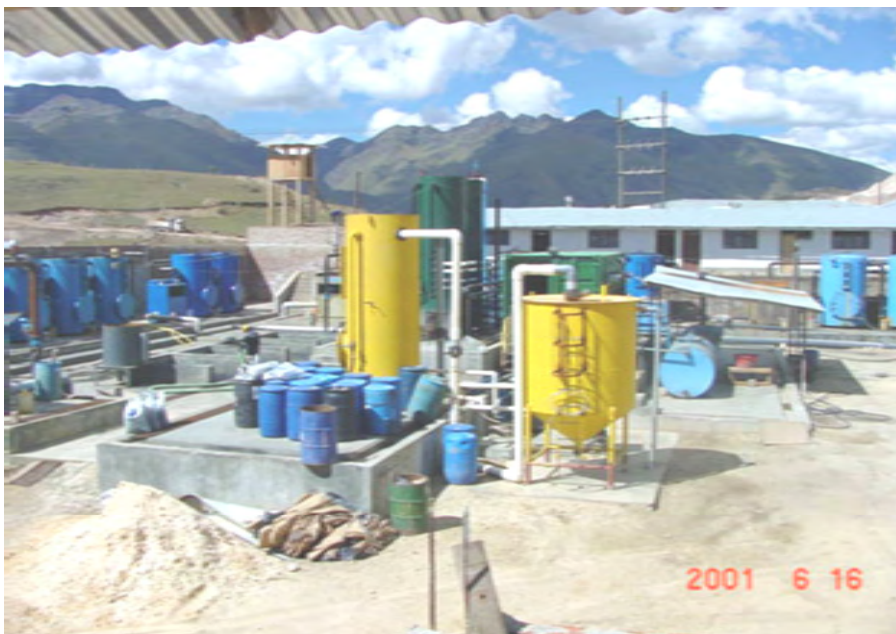
Figura 83. Planta de reactivación química y circuitos de adsorción
