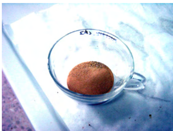
Fig 23. La arena una vez seca es el momento de proceder al tamizado. tapa base, y se pesa para obtener las diferentes fracciones.
