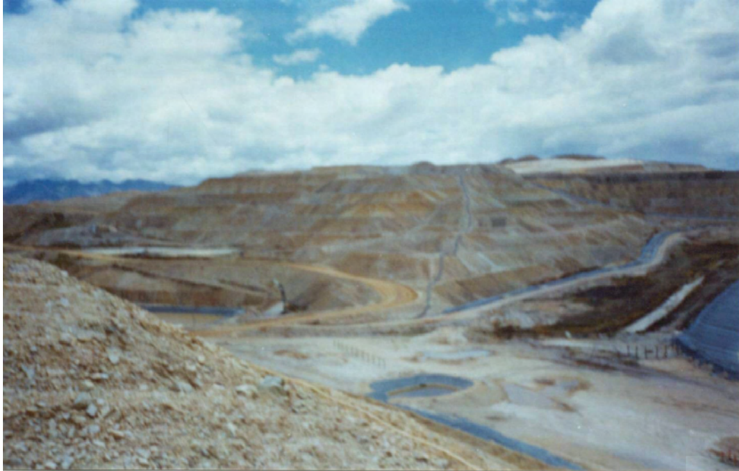
Figura 76. Lixiviación por heap leaching en pisos múltiples
