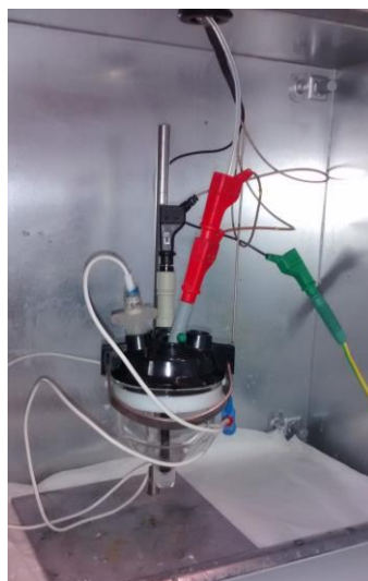
Figura 2.4. Celda electroquímica con sistema de tres electrodos
