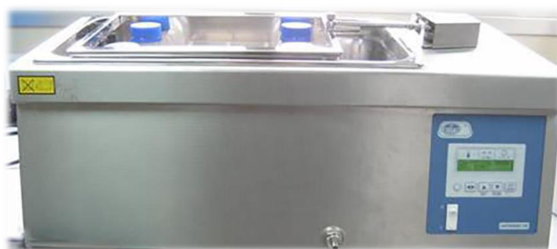
Figura 2.2. Instalación de experimentos para adsorción en discontinuo
