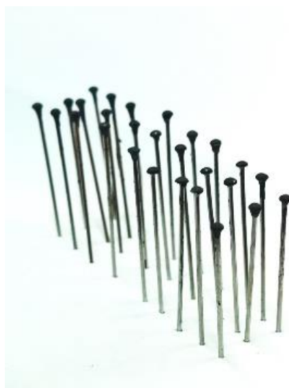
Figura 16: Electrodo de trabajo listo para su uso, formado por alfileres de acero inoxidable y tinta de carbono.
