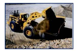
Para vaciar el material del cazo de forma satisfactoria, al mismo tiempo que se voltea se deberá desplazar la pala hacia adelante en dirección al camión. Se deberá prestar atención a esta maniobra ya que, si no se ejecuta correctamente, la pala podría golpear el camión.
