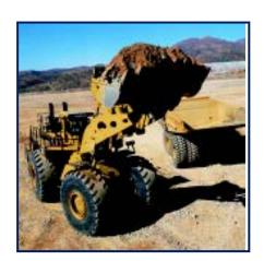
Cuando el camión se encuentre en la posición correcta, el operador de la pala lo indicará por medio de un ligero toque de claxon y volcará el cazo, comenzando la operación de carga.
