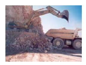
Cuando se carga el camión por la parte trasera, comenzar cargando desde delante hacia atrás. Repartir la carga de forma homogénea.
