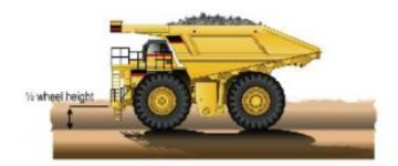
La altura de los mismos debe ser igual al radio de la rueda del vehículo más grande existente en el proyecto. Así mismo, deben ser construidos con materiales sólidos adecuados y con la densidad suficiente para garantizar una protección efectiva.
