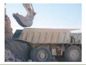
Realizar la operación de carga desde el lateral o desde la parte trasera del camión, según las condiciones del tajo. No pasar nunca el cazo sobre la cabina.
