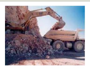
5. Para descargar el material, mover el balancín hacia fuera y abrir el cazo lentamente. En el caso de que el material sea roca, evitar la caída brusca del material sobre la caja del camión.
