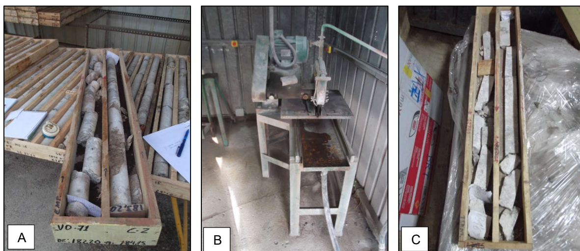
Figura 15. A) Testigo extraído en un sondeo. B) Cortadora. C) Testigo cortado a la mitad.
