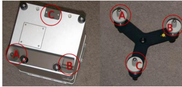
Figura 5.9. Vista inferior del CG-5 (izquierda) y trípode (derecha). Obsérvese las indicaciones sobre la disposición correcta de los punzones del trípode sobre la base del gravímetro (A, B y C)
