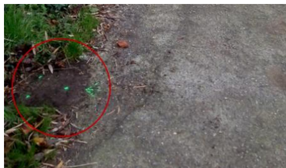
Figura 5.8. Marcaje de los puntos de estacionamiento del gravímetro (destacado en círculo rojo)
