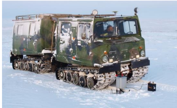
Figura 5.4. Campaña gravimétrica de prospección de yacimientos de petróleo y gas en Siberia (Federación Rusa). El transporte del CG-5 se realiza mediante vehículo con orugas debido a la dificultad del terreno y a la ausencia de carreteras (Niimorgeofizika-Group, 2009)
