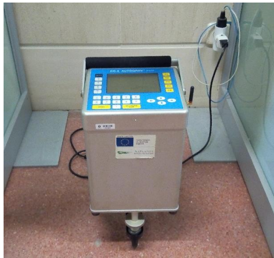
Figura 4.1. Gravímetro Scintrex CG-5 Autograv S/N 081240489. Es el equipo empleado en este Trabajo. La fotografía se corresponde con su base en el laboratorio de la Unidad de Modelización Hidro-Geofísica y de ensayos No Destructivos de la Universidad de Oviedo (Mieres, España).
