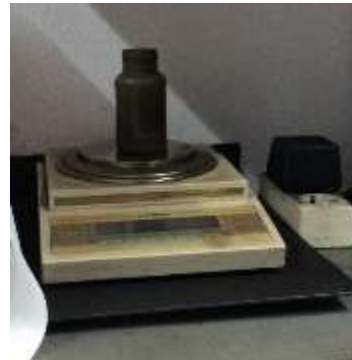
Fotografía 15: Bote para pesar (izda.) y báscula (drcha.). Fuente: propia
