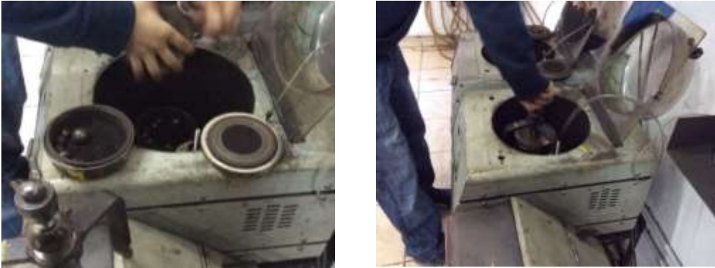
Fotografía 21: Introducción de las muestras en los molinos. Fuente: propia
