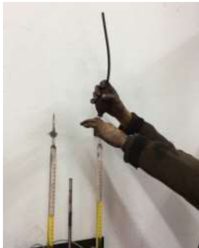
Fotografía 18: Nivelación de las pipetas. Fuente: propia
