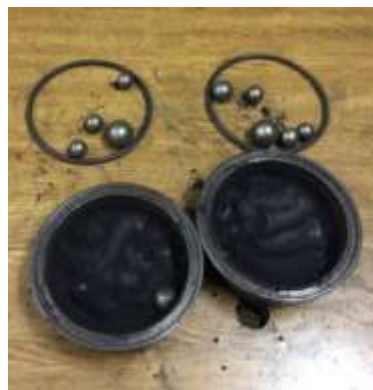
Fotografía 16: Recipientes para el molino de bolas. Fuente: propia
