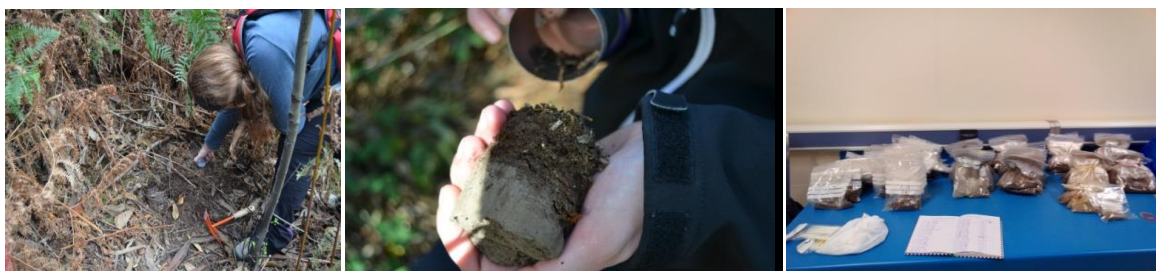
Figura 11: a) Extracción del anillo metálico con la muestra. B) muestra extraída del anillo metálico. Se diferencian perfectamente el horizonte orgánico superior del horizonte mineral inferior c) Muestras embolsadas y ordenadas listas para analizar en el laboratorio.
