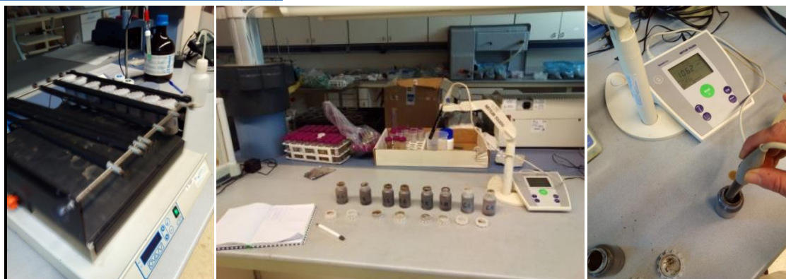
Figura 17: a) Fotografía de muestras en la centrifugadora. b) Muestras en las lecheras preparadas para medir la conductividad eléctrica y aparato de medición c) Midiendo la CE de las muestras.
