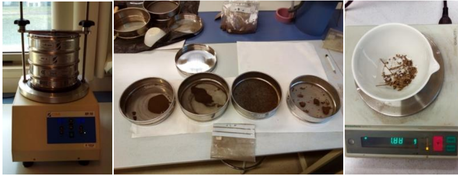
Figura 14: a) Torre de tamizado b) Tamices utilizados con las fracciones correspondientes a la muestra A3.3. c) Pesaje de fracción de tamaño grava (>2mm).
