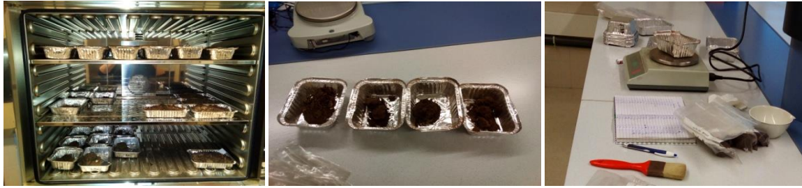
Figura 12: a) estufa de secado con muestras correspondientes al horizonte mineral b) muestras secas del horizonte mineral c) Pesaje de muestras secas para determinar la humedad del horizonte mineral.
