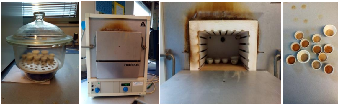
Figura 15: a) Muestras enfriándose en la desecadora de vidrio. b) Imagen de la mufla en su totalidad preparada a 450 0 C. c) Crisoles con las muestras dentro de la mufla. d) Crisoles con las muestras tras salir de la mufla después de quemar todo el carbono orgánico presente en ellas.
