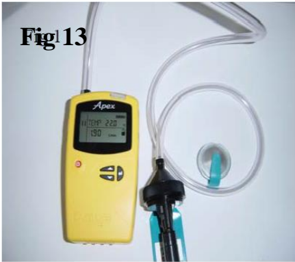
Fig 13 y Fig 14: aparato medidor de polvo respirable y curva de polvo respirable
