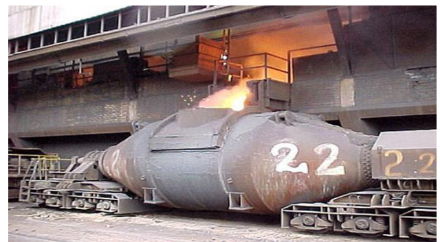
Figura 1. Vaciado de arrabio sobre carro torpedo [1]
