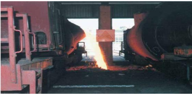
Figura 2. Trasvase de arrabio del torpedo a la cuchara
