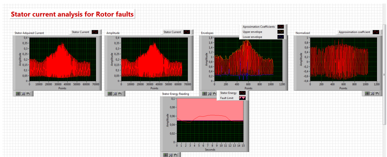
Figure 24. Test défaut rotorique
