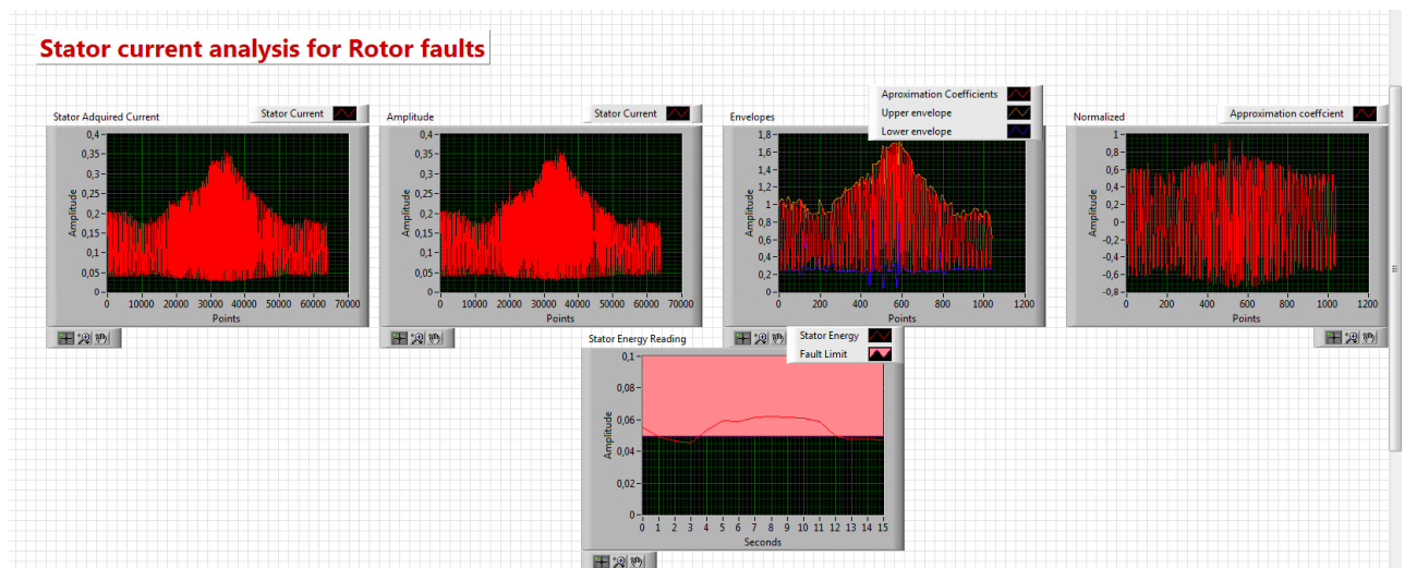
Figura 24. Test fallo rotórico
