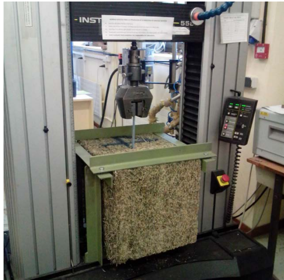
Figura 16: bloque de WWW siendo ensayado a tracción mediante un conector y adhesivo de mortero
