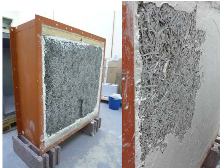
Figura 19: colocación del panel WW en el bastidor y aplicación de los acabados
