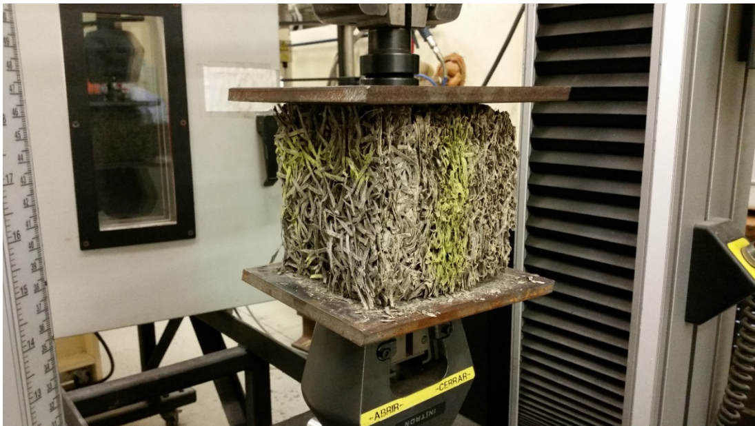
Figura 14: detalle de las chapas y la rótula utilizada en los ensayos de compresión
