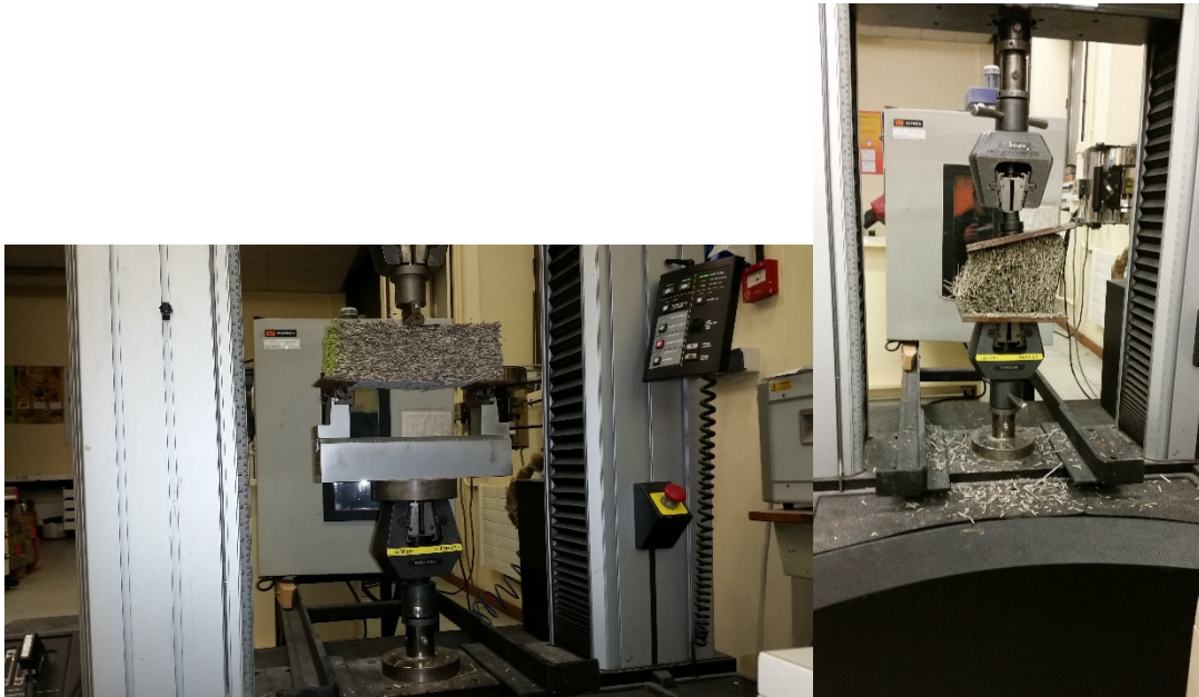
Figura 15: rotura de dos probetas ensayadas a flexión y compresión
