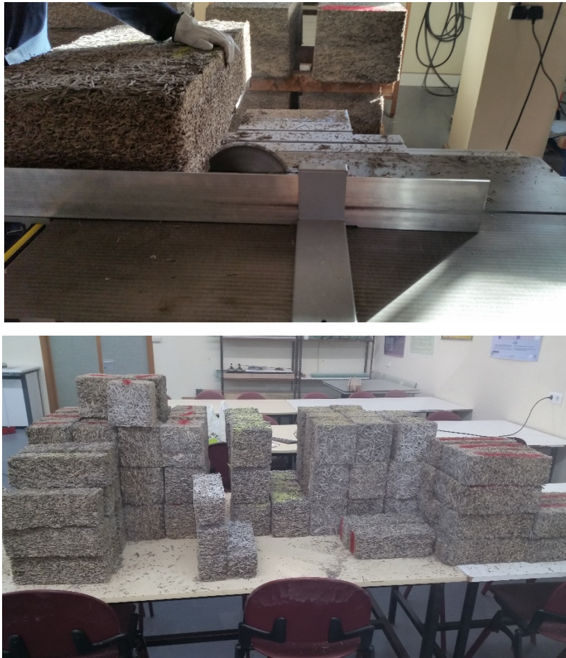
Figura 9: mesa de corte empleada y probetas de compresión y flexión de dos densidades diferentes
