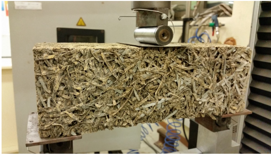
Figura 13: detalle de la chapa flexible que evita la incrustación
