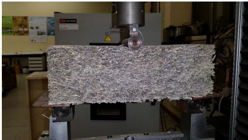
Figura 12: penetración de la célula en el material
