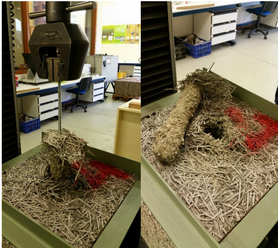
Figura 18: extracción de la varilla a tracción
