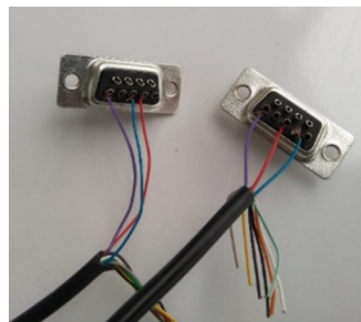
Imagen 14. Conexionado de los terminales.
