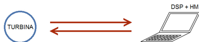
Imagen 3. Arquitectura con un solo equipo.
