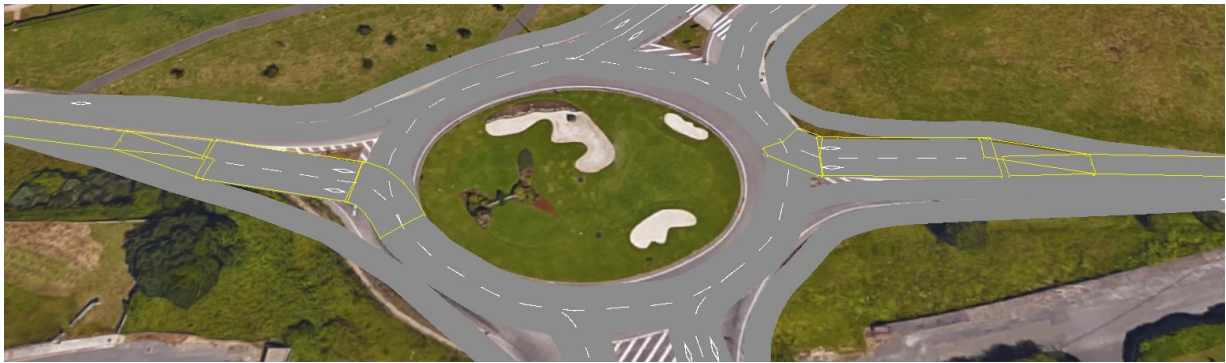
Figura 8.2. Duplicación de los carriles en las entradas de Viesques y Escuela Politécnica
