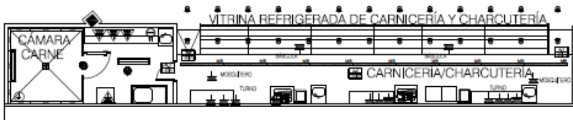
Figura 5. Iluminación de la zona de tras-mostradores de la sección de carnicería y charcutería de un supermercado
