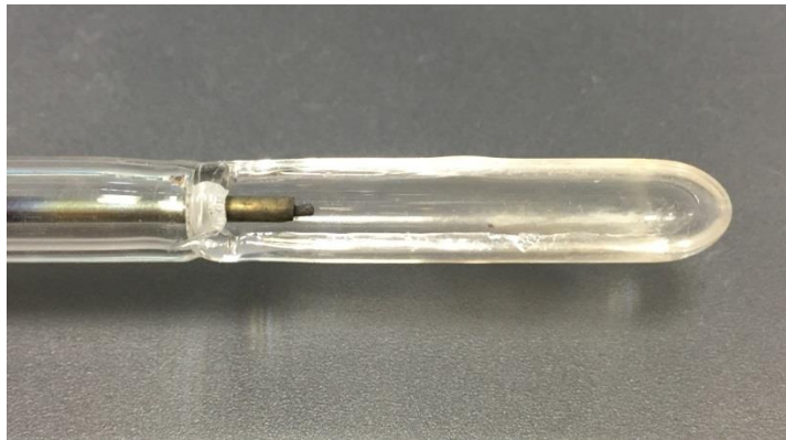
Figura 3.1.4. Detalle de la navecilla portamuestras
