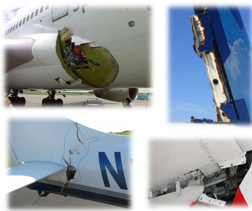
Figura 2.5. Ejemplos de deslaminación en aeronaves.
