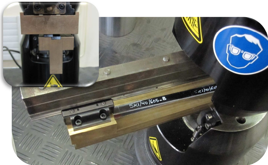
Figura 4.16. Fin del ensayo, probeta totalmente deslaminada.
