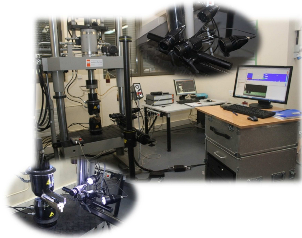
Figura 4.7. Equipo para videocorrelación de imágenes digitales Aramis 5M .
