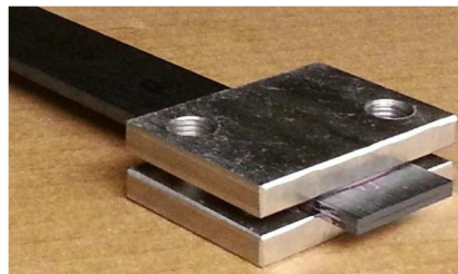
Figura 3.48. Disposición de los “ tabs ” de carga sobre la probeta SST “ Split Shear Torsión ”, Johnston y Davidson [117].
