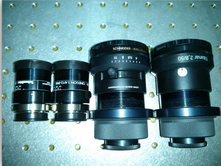
Figura 4.18. Diferentes juegos de lentes utilizadas por el equipo Aramis.
