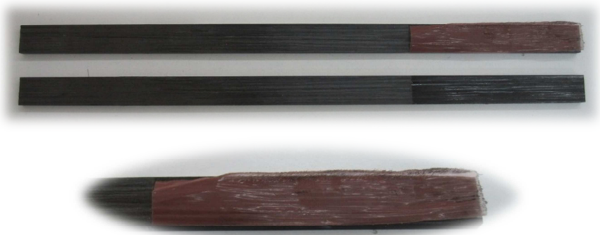
Figura 4.4. Probeta completamente deslaminada. Detalle del film desmoldante (RF-242 Tygavac ).
