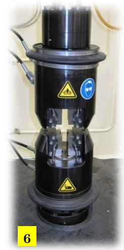
Figura 4.6. Máquina servohidráulica w+b (walter+bai ag) .
