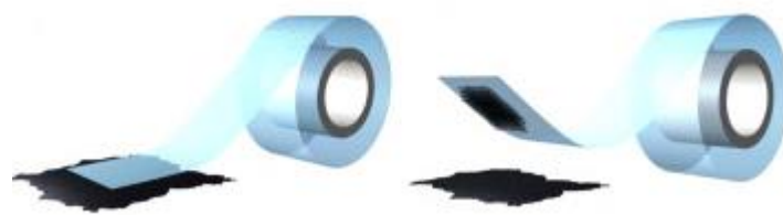
Figura 1.5. Exfoliación mecánica descrita por Novoselov y Geim en 2004.
