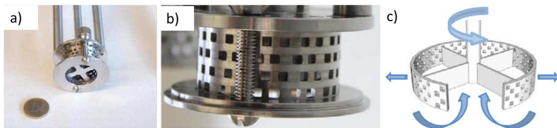
Figura 1.10. a) y b) Imagen de las navajas con una apertura de 32 mm que van conectadas a un motor giratorio y c) se muestra una ilustración del funcionamiento de la navaja en LPE.
