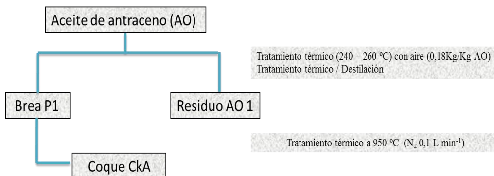
Figura 3.1. Esquema de obtención de breya a partir de aceite de antraceno (AO).
