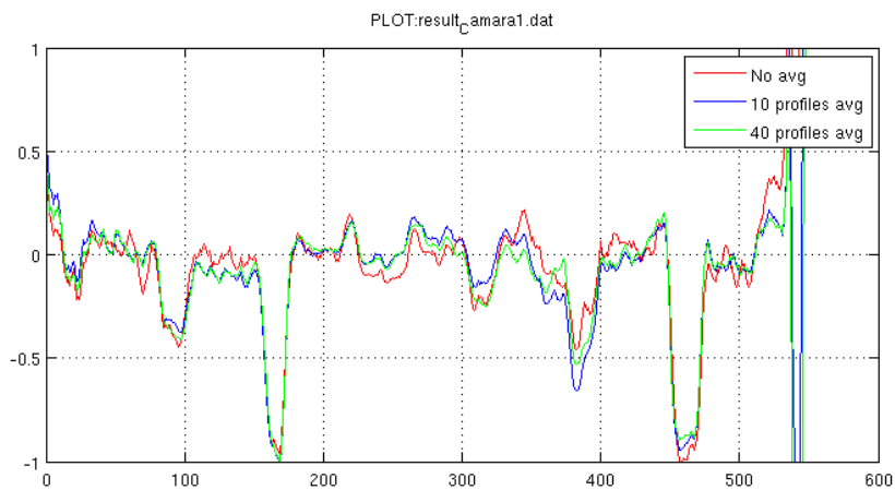
Figura 1.7: Perfil de un patrón de calibración mecanizado con surcos con profundidades 0.05mm, 0.1mm, 0.2mm y 0.5mm; la imagen muestra un solo perfil, el promedio de 10 perfiles y el promedio de 40 perfiles. La adquisición se realizó en movimiento y a una distancia de 800mm.
