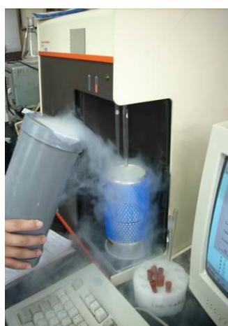
Figura 3.8 Equipo Micromeritics Gemini 2360 para determinación de la superficie específica y porosidad de una muestra sólida por técnica de adsorción de N_2 . (Laboratorio Catálisis Ing. Química UDEC)
