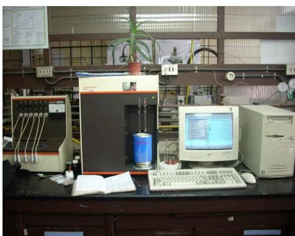
Figura 3.8 Equipo Micromeritics Gemini 2360 para determinación de la superficie específica y porosidad de una muestra sólida por técnica de adsorción de N_2 . (Laboratorio Catálisis Ing. Química UDEC)
