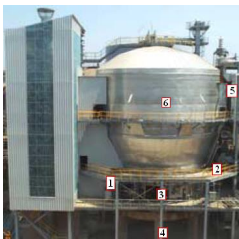
Figura 3.1 HLFEB para la tostación de concentrado de cinc [1] .
