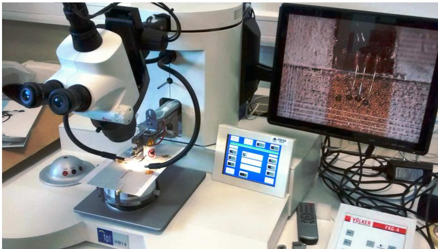
Figura 4.6: Fotografía de la máquina de bonding utilizada.
