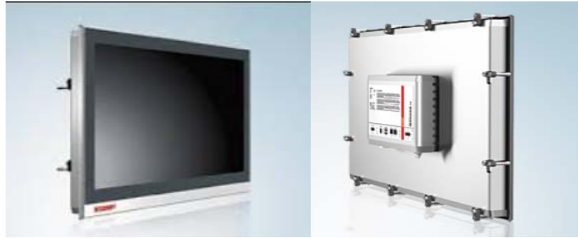
Figura 39 : Pantalla táctil modelo CP-2612 del fabricante Beckhoff.
