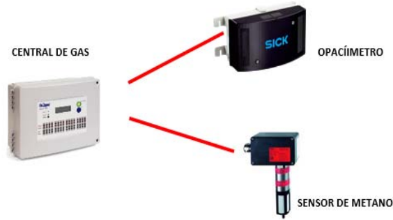
Figura 5: Esquema conexionado equipos a Central de Gas.
