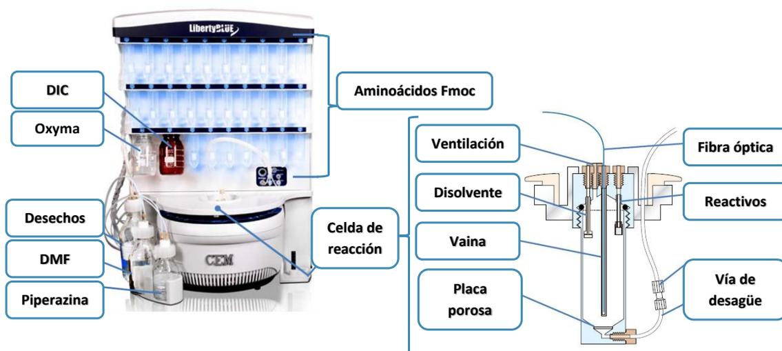
Fig. 10 – Sintetizador de péptidos *LibertyBlue*. El sistema se compone de dos partes: dispensador de reactivos (diferentes posiciones para colocar los aminoácidos, celda de reacción y desagüe) y generador de microondas (rodeando la celda de reacción).
