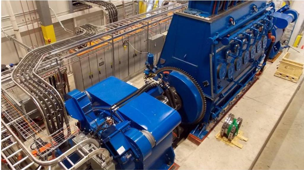
**FIGURA 19: MÁQUINA SUSTAINX PARA ALMACENAMIENTO DE AIRE
