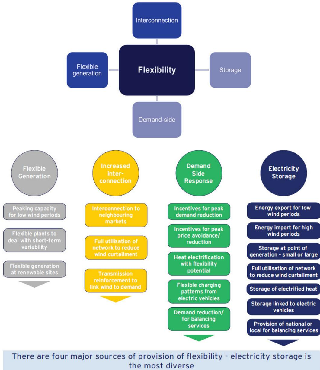
**FIGURA 5: COMPARACIÓN ENTRE LAS 4 FORMAS PRINCIPALES DE EQUILIBRADO DEL SISTEMA ELÉCTRICO**
