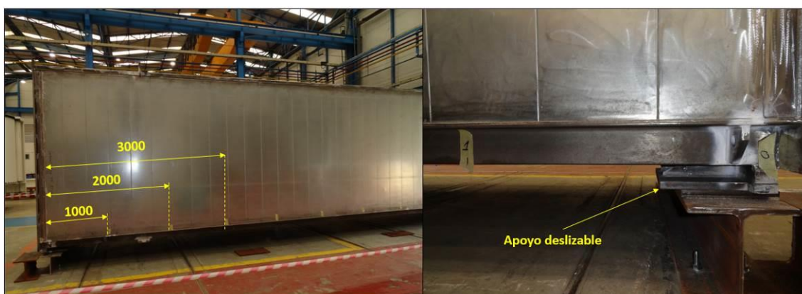
Imagen 39: Marcas numeradas para control de desplazamiento vertical con dispositivo laser [mm].
