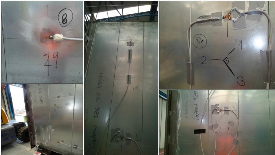
Imagen 34: Galgas y rosetas colocadas en el lateral del túnel.
