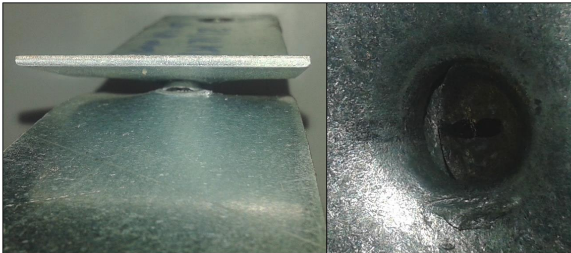
Imagen 14: Vista en detalle del inicio de fallo en el punto de soldadura.
