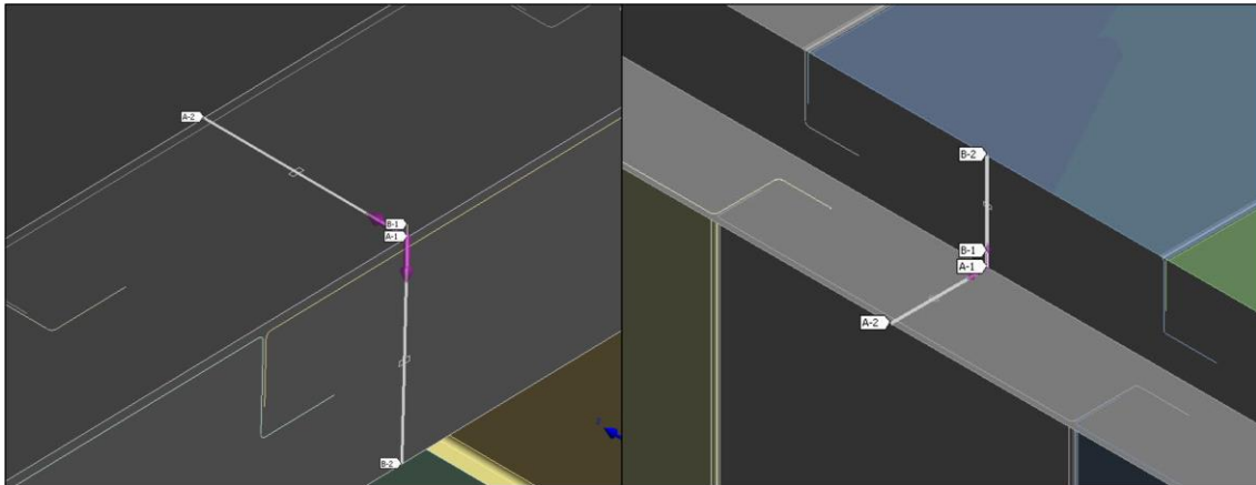
Imagen 125: Detalle de los “paths” creados para la obtención de los resultados en las galgas 9, 10, 11 y 12.
