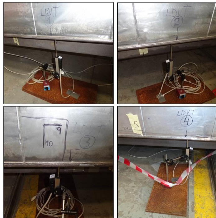
Imagen 37: Disposición de los cuatro transductores para desplazamiento vertical.
