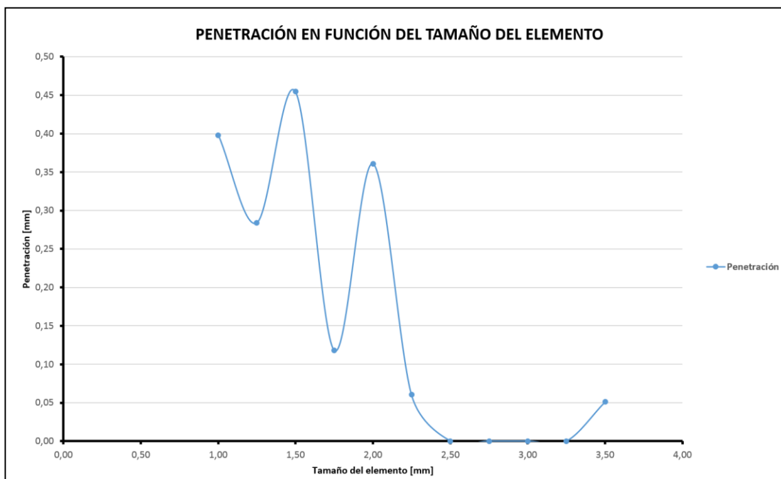
Gráfica 63: Penetración en las inmediaciones del punto de soldadura en función del tamaño de elemento.
