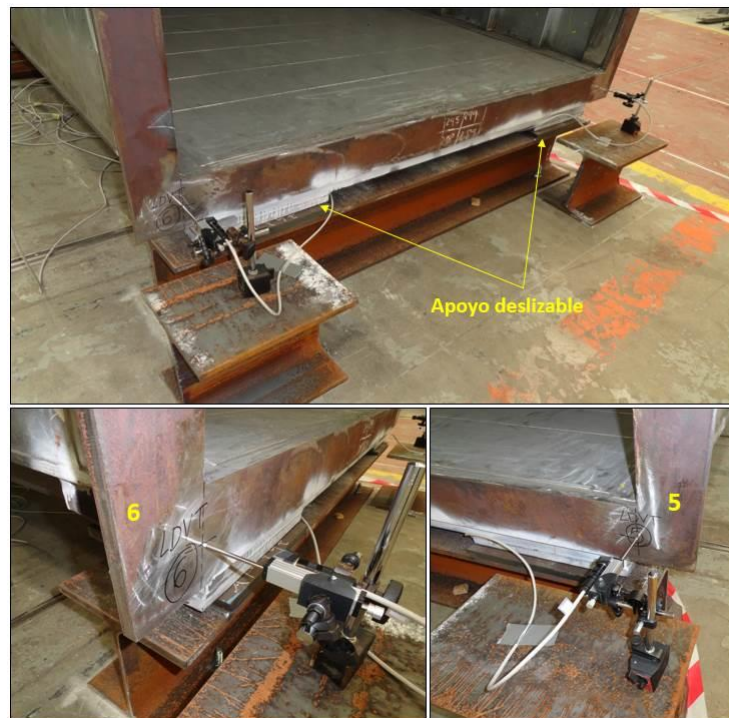
Imagen 38: Transductores de desplazamiento horizontal.
