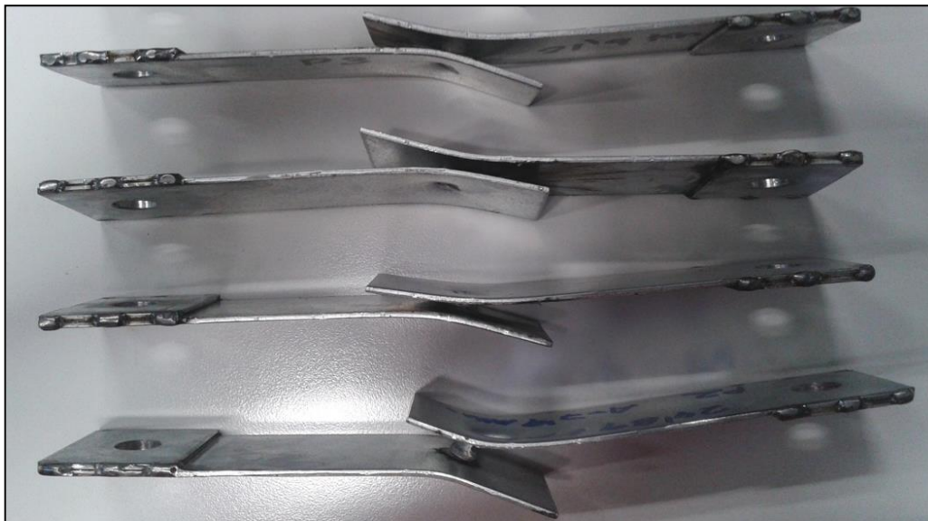
Imagen 16: Probetas con deformación progresiva. Rotura tipo III.
