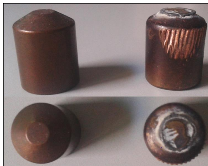
Imagen 10: Cabezal de soldadura nuevo (izquierda), y usado (derecha).
