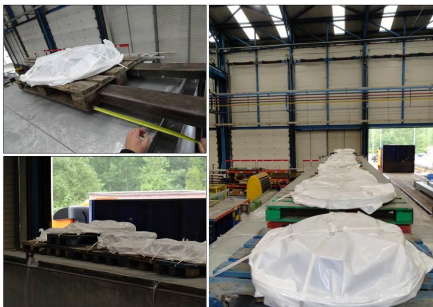
Imagen 46: Aplicación de la carga de techo.
