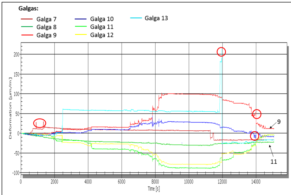
Gráfica 44: Deformaciones en las galgas 7 a 13 durante la prueba [ \mu\text{m}/\text{m} ].
