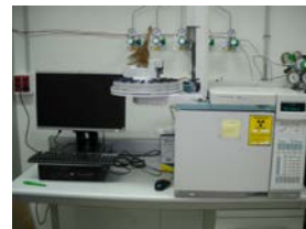
Figura 22. Cromatografía de gases para detectar compuestos tóxicos volátiles.
