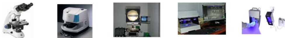
Figura 12. Instrumentación empleada en Documentoscopia. De izquierda a derecha: Microscopio binocular, microscopio de infrarrojos, proyector de perfiles, comparador video-espectral y Fluotest.
