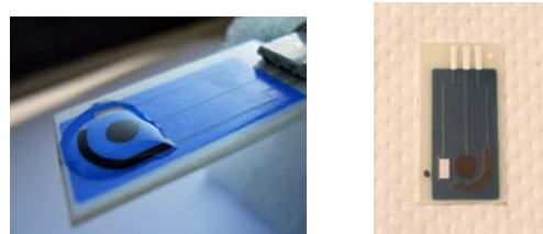
Figura 24. Biosensor basado en tecnología serigráfica.
