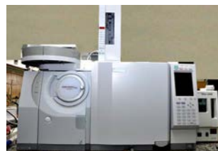
Figura 20. Cromatografía gaseosa acoplada con un detector selectivo de masas, detecta la mayoría de las drogas y tóxicos.
