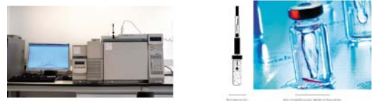
Figura 14. De izquierda a derecha, cromatógrafo de gases-masas para incendios y "microextracción en fase sólida".
