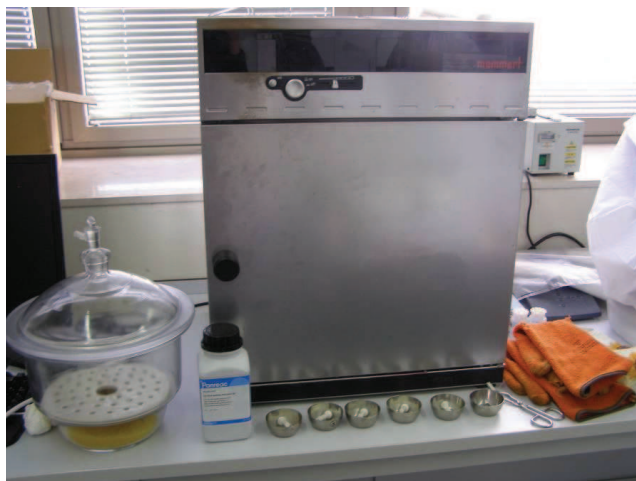
Figura 3.26. Dispositivo para determinación de humedad: desecador, arena, pocillos y horno.
