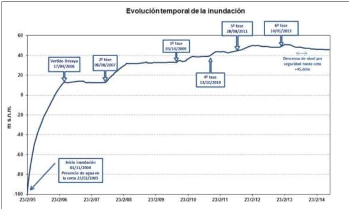
Figura 2. Gráfico de la evolución del nivel piezométrico medido en el Pozo (PSA).
