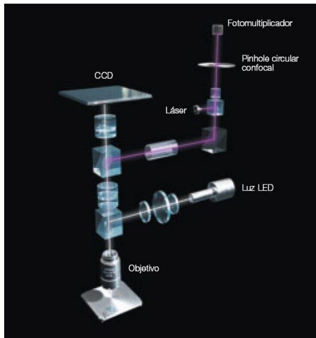
Figura 3.11: Esquema de la configuración del microscopio confocal.
