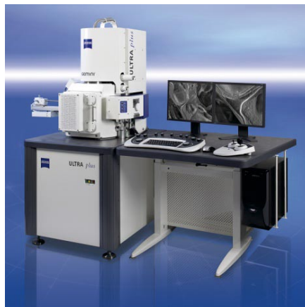
Figura 3.10: Microscopio electrónico de barrido, Zeiss modelo Gemini ULTRA Plus.
