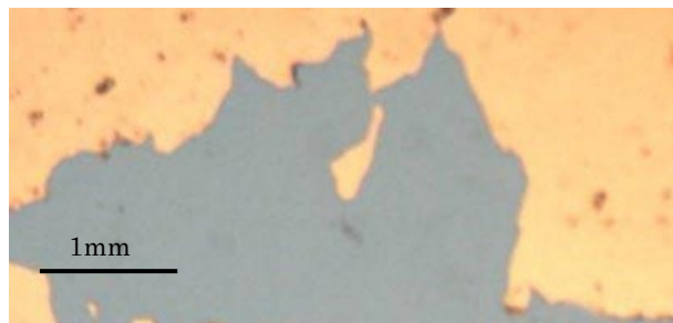
Figura 4.2: Capa de cobre levantada del sustrato tras el proceso de recocido.
