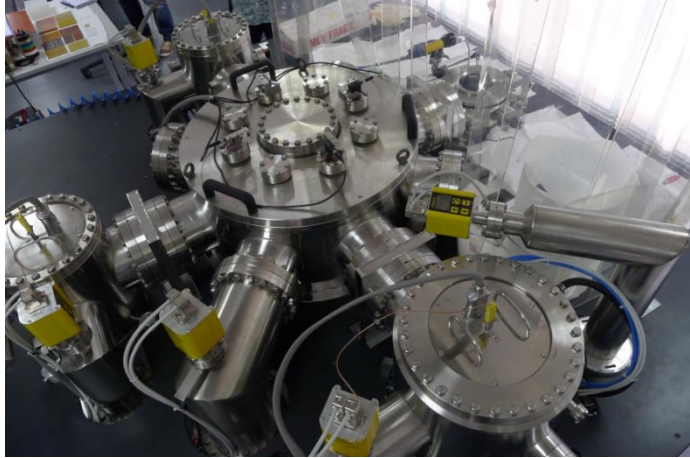
Figura 3.4: Sistema de CVD asistido por plasma.
