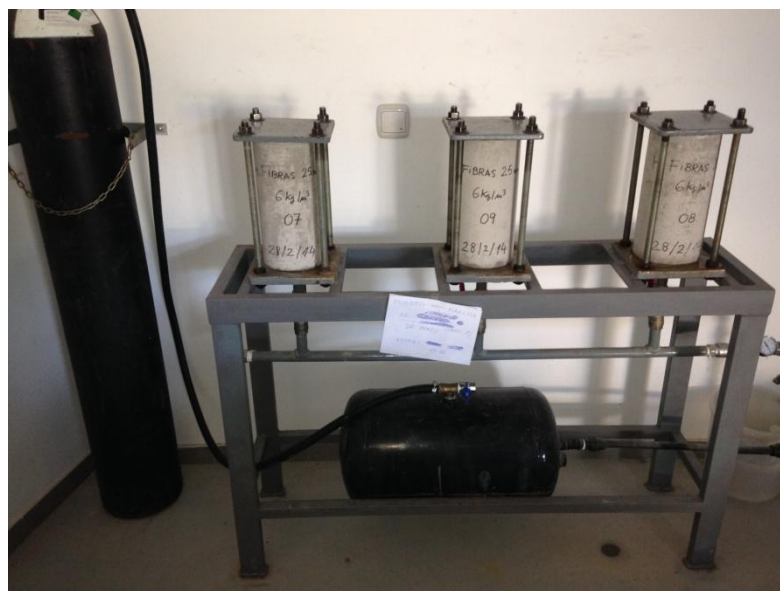
Fig. 21: Probetas cilíndricas durante ensayo de penetración de agua
