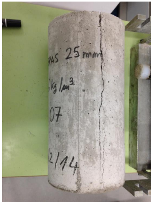
Fig. 27: Probeta rota mediante tracción indirecta
