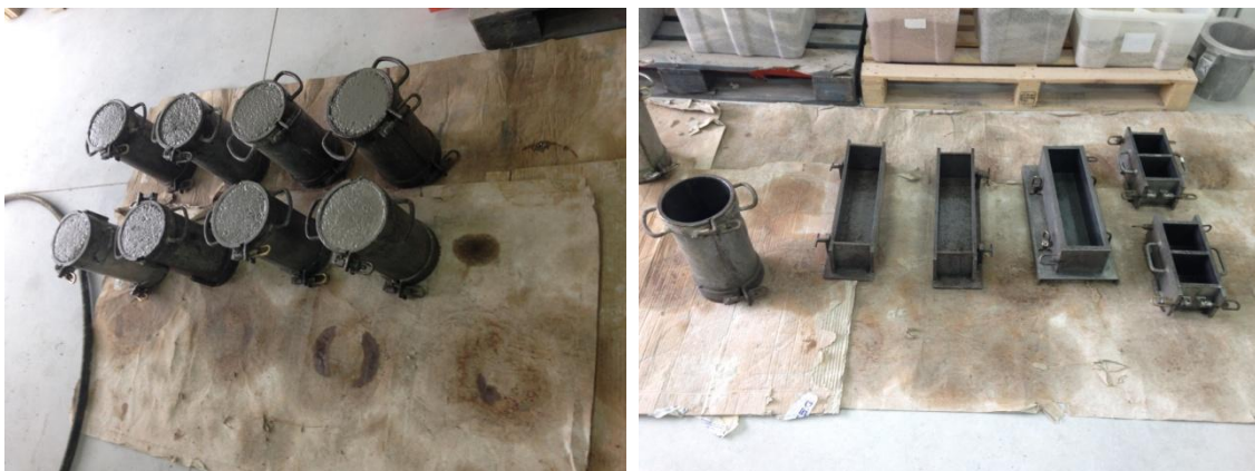
Fig. 8: Probetas normalizadas cilíndricas y prismáticas para el vertido del hormigón reforzado con fibra de vidrio AR
