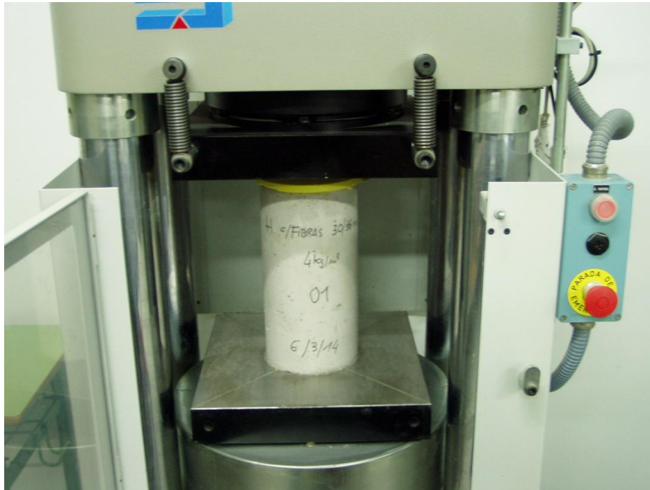
Fig. 18: Probetas cilíndricas normalizadas y refrentada colocada previa realización del ensayo a compresión
