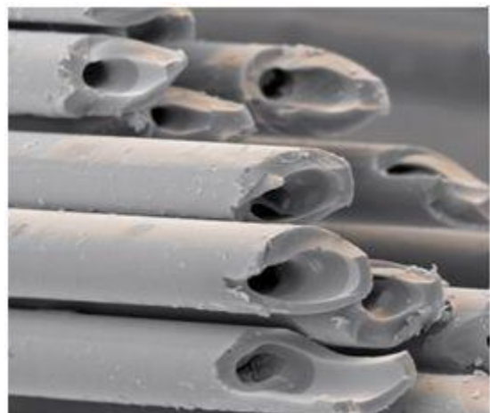
Fig. 2. Fibras de vidrio vistas a través de un microscopio electrónico de barrido
