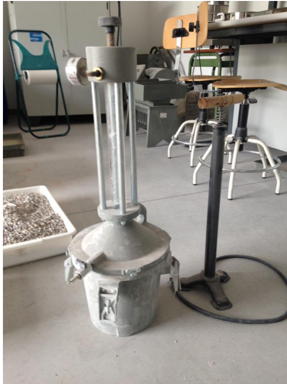
Fig. 31: Aparato para realización de ensayo de aire ocluido sobre hormigón en estado fresco
