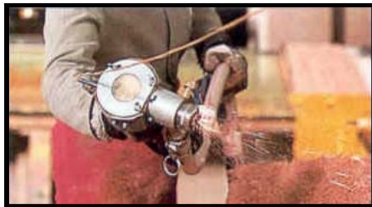
Fig. 3. Proyección manual de fibras mediante pistola
