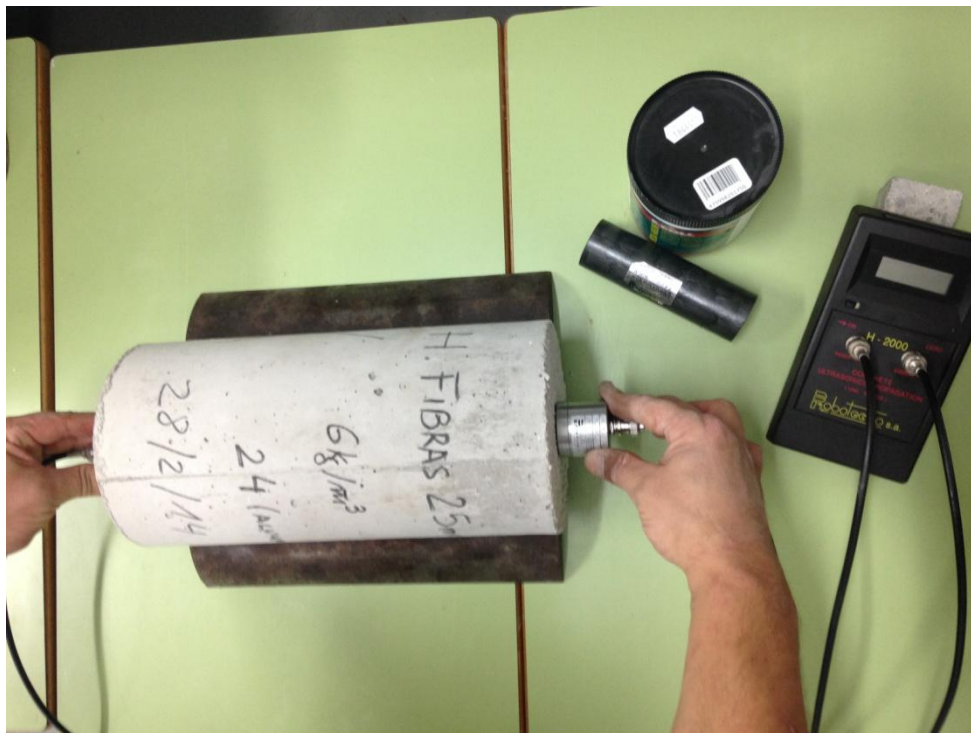
Fig. 28: Realización de ensayo de ultrasonidos
