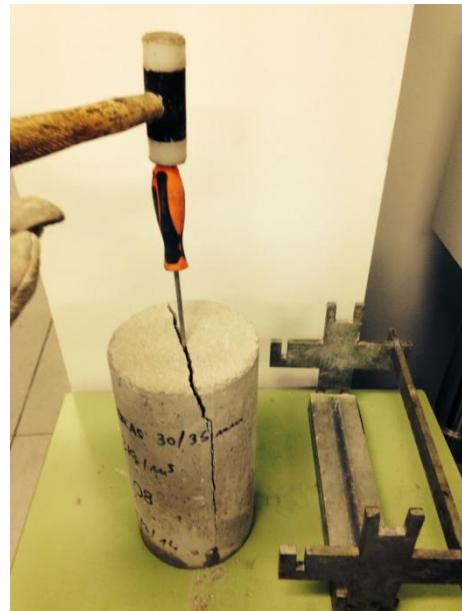
Fig. 22: Rotura de probeta posterior al ensayo de penetración de agua
