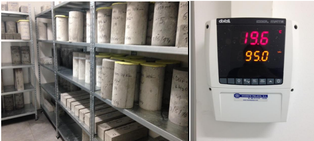
Fig. 9: A) Cámara climática para el curado de las probetas de hormigón. B) dispositivo de control de la cámara el cual indica la temperatura y la humedad relativa a la cual se encuentra ésta
