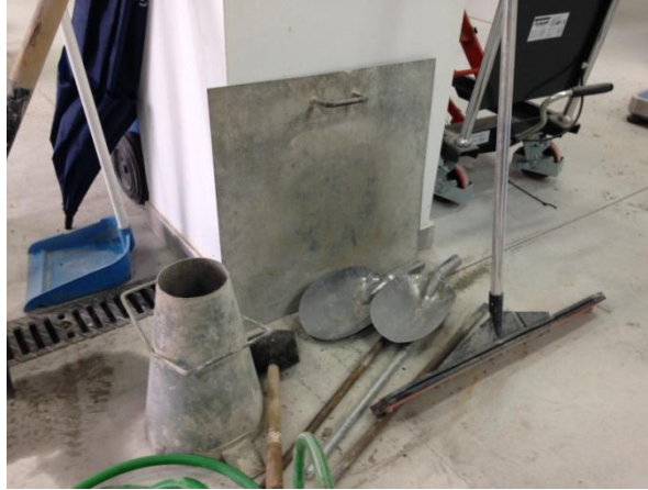
Fig. 29: Cono de Abrams y placa rígida
