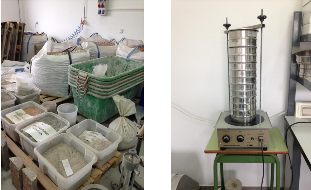
Fig. 5: A) Áridos calizos triturados utilizados en la realización de del hormigón reforzado con fibra de vidrio AR. B) Relación de tamices utilizados para analizar la granulometría de la grava y la arena según norma NLT-150
