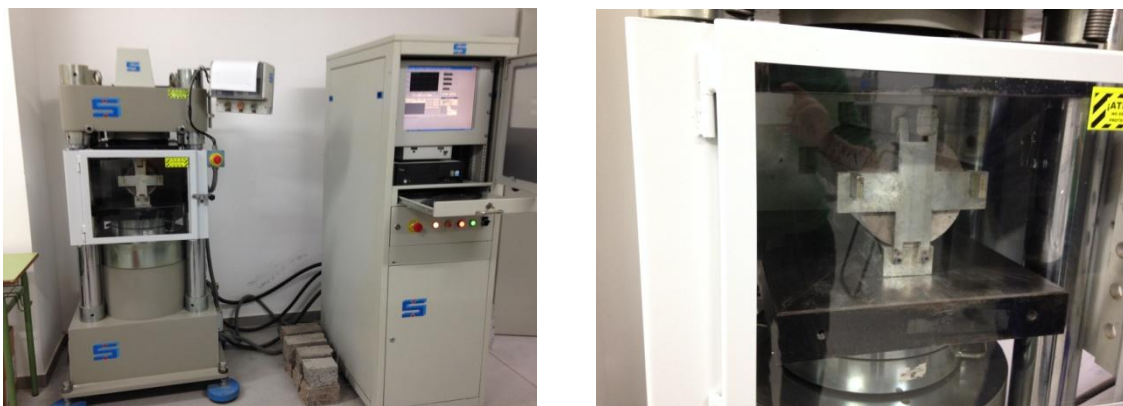
Fig. 26: A) Máquina de ensayo brasileño del Laboratorio de Hormigón. B) Probeta introducida en máquina previa a la realización del ensayo de tracción indirecta
