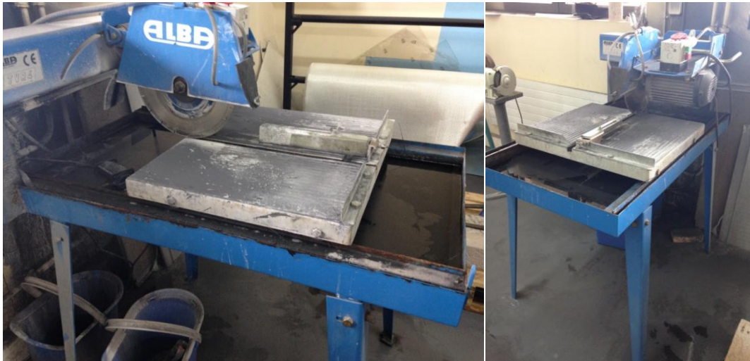
Fig. 13: Máquina cortadora ALBA TRV4 con sierra de disco de diamante para realización de entallas en probetas de hormigón
