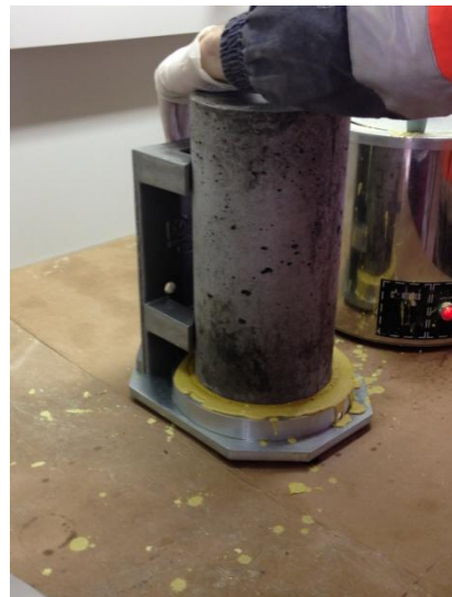
Fig. 11: Realización de refrentado sobre probeta de hormigón
