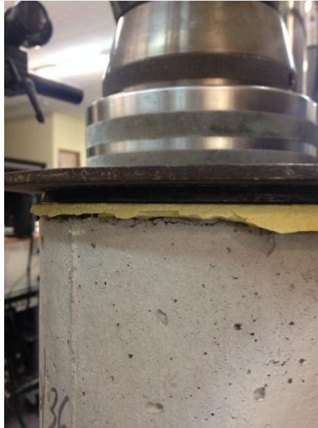
Fig. 41: Unión deficiente entre el plato y la probeta debido a un mal refrentado de ésta
