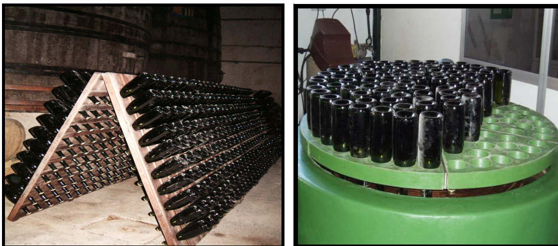
Figura 1.1.10. Pupitre con botellas colocadas (izqda.) y máquina para congelación de cuellos (dcha.). Por cortesía de “Valle, Ballina y Fernández” (Villaviciosa).
