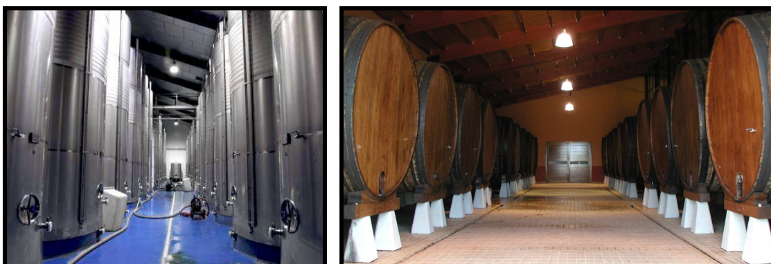
Figura 1.1.8. Toneles de acero inoxidable y de madera. Por cortesía de Sidra “Cortina” y Sidra “El Gobernador” (Villaviciosa).
